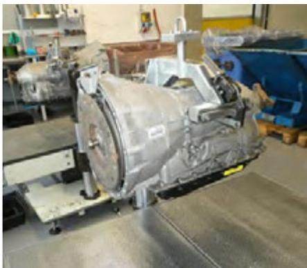
Getriebezerlegung: Getriebe eines BMW aus der 5er-Reihe
